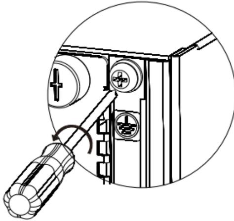
图4-28 松开设备接地端子的螺钉示意图
