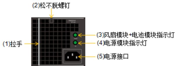
图3-43 DSU5625B 风扇模块+电池模块+电源模块正视图
