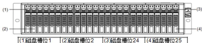
图6-35 DSU5625B/DSU5625 磁盘槽位编号示意图
