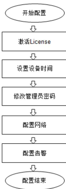
图5-4 设备初始配置流程示意图
