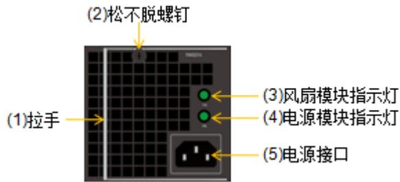
图3-44 DSU5625 风扇模块+电源模块正视图
