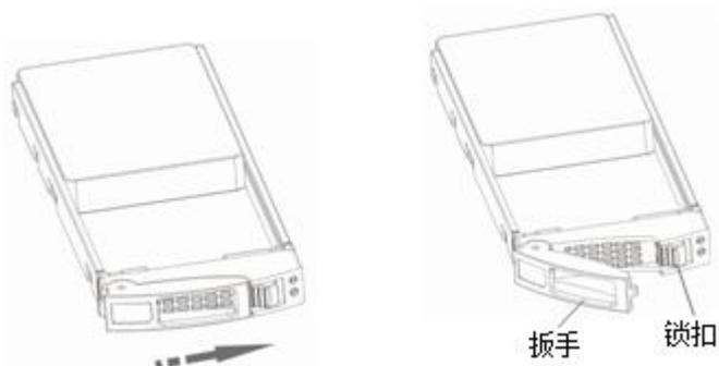
图6-36 安装 NVMe 磁盘模块示意图（一）
