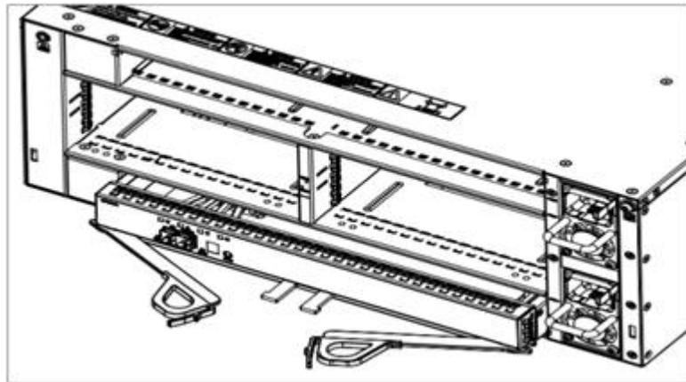
图6-7 安装/拆卸 DSU2624 EP 示意图
