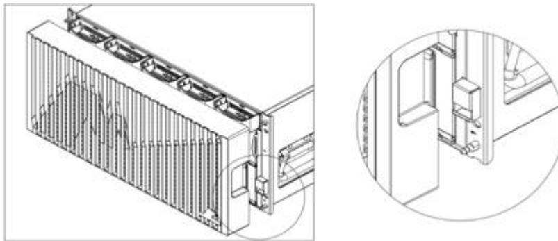
图4-15 安装 SPU 面板示意图
