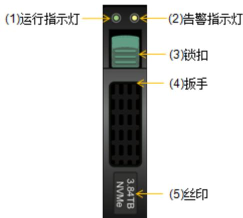
图3-45 NVMe 磁盘模块前面板
