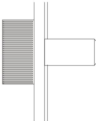
图7-4 拇指螺钉与方孔条表面贴平
