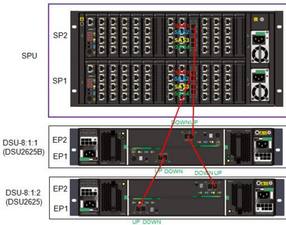
图4-39 SAS1 接口上 SAS 线缆安装示意图
