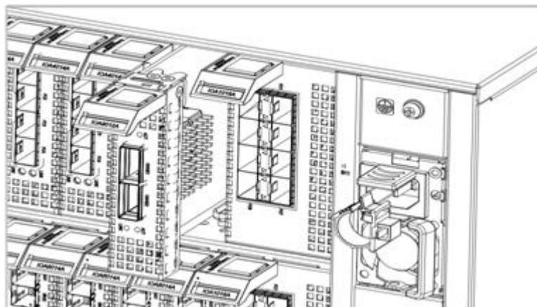
图6-5 安装/拆卸 IO 插卡示意图
