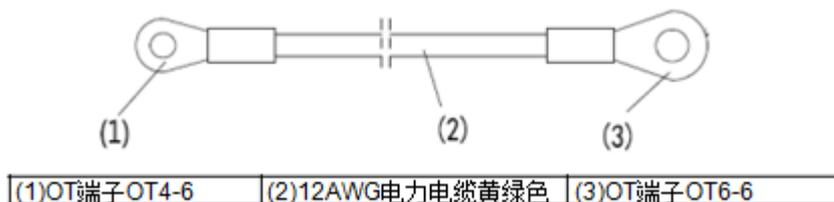
图4-27 接地线示意图
