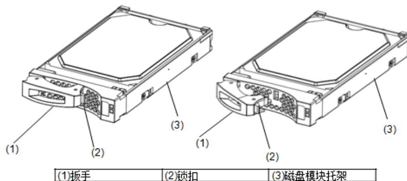
图6-30 3.5 英寸磁盘模块示意图
