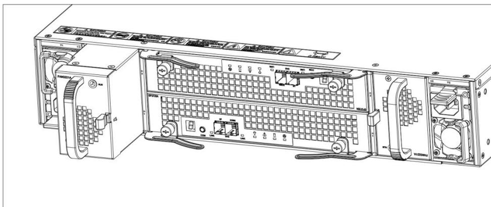
图6-17 安装/拆卸 DSU2725 后端风扇模块示意图
