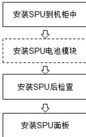
图4-12 SPU 安装流程示意图
