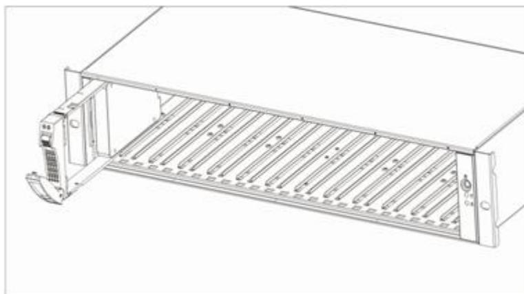
图6-29 安装 2.5 英寸磁盘模块 B 示意图（二）
