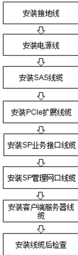
图4-26 线缆安装流程示意图
