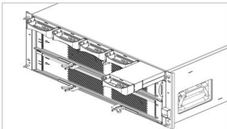
图4-14 安装 SPU 电池模块示意图
