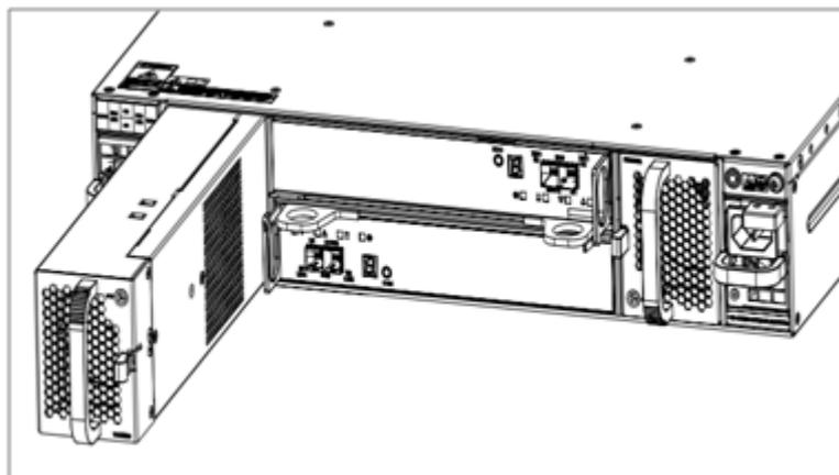
图6-13 安装/拆卸 DSU2625 风扇模块示意图
