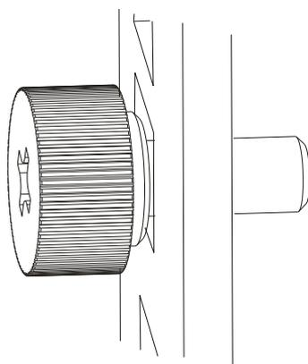
图7-6 拇指螺钉错误安装示意图（二）
