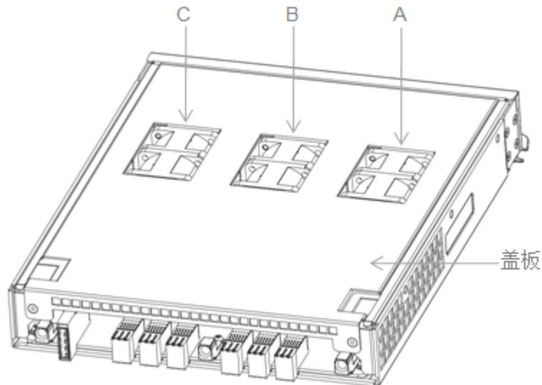
图6-15 DSU2725B/DSU2725 内置风扇模块安装位置示意图
