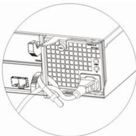
图4-33 安装电源线示意图 (三)
