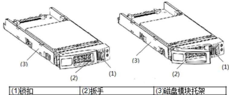
图6-22 2.5 英寸磁盘模块 A 示意图
