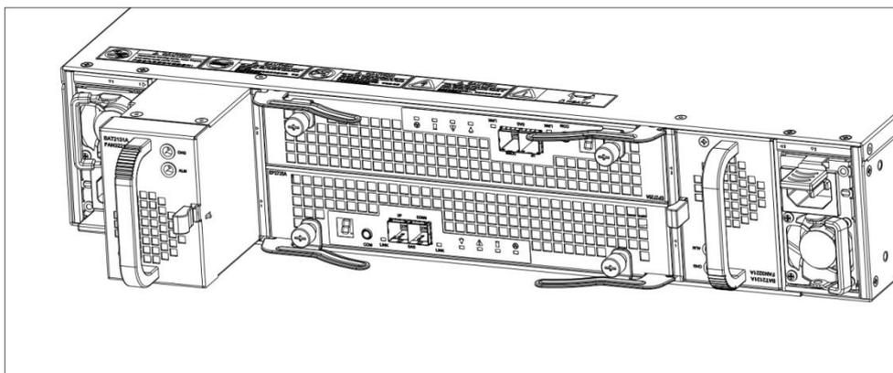
图4-20 安装 DSU2725B 风扇模块+电池模块示意图
