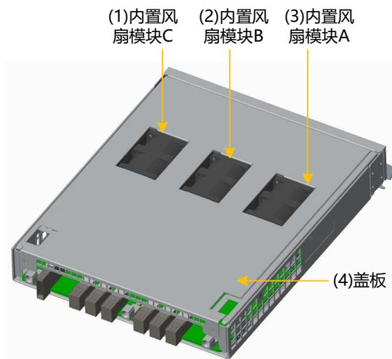
图3-33 DSU2725B/DSU2725 内置风扇模块安装位置示意图
