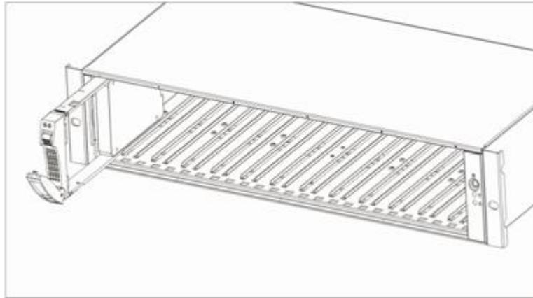
图6-37 安装 NVMe 磁盘模块示意图（二）
