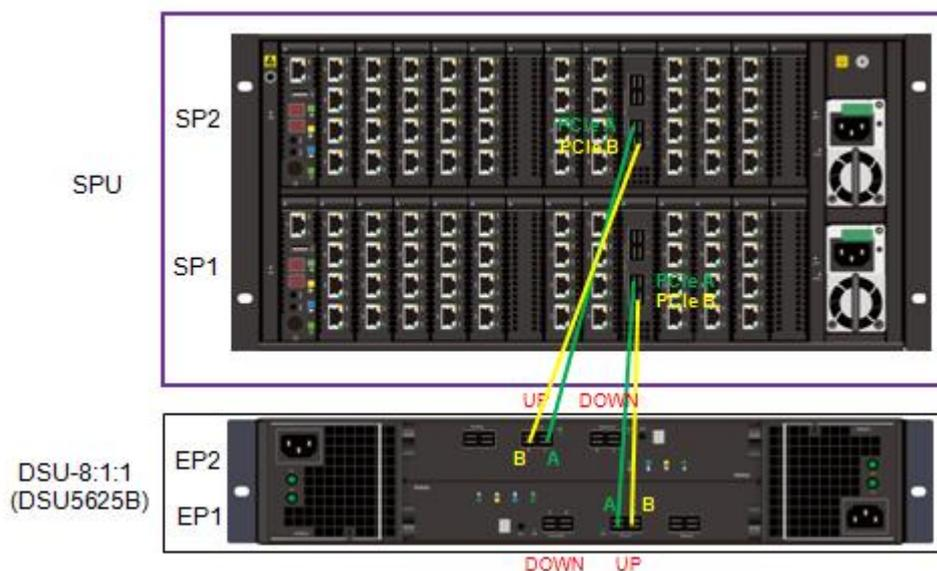
图4-41 PCIe 扩展线缆安装示意图
