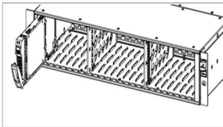
图6-25 安装 2.5 英寸磁盘模块 A 示意图（二）
