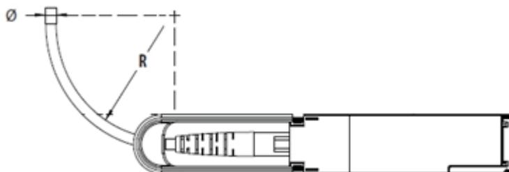
图4-38 AOC 光缆弯曲半径示意图
