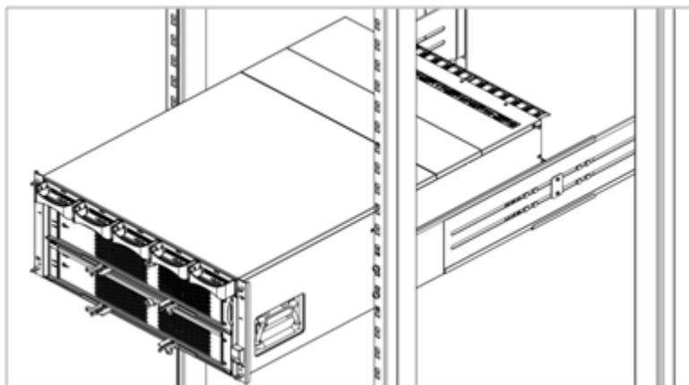
图4-13 安装 SPU 示意图
