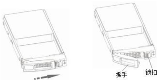
图6-28 安装 2.5 英寸磁盘模块 B 示意图（一）
