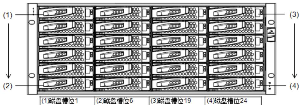
图6-31 DSU2624B/DSU2624 磁盘槽位编号示意图
