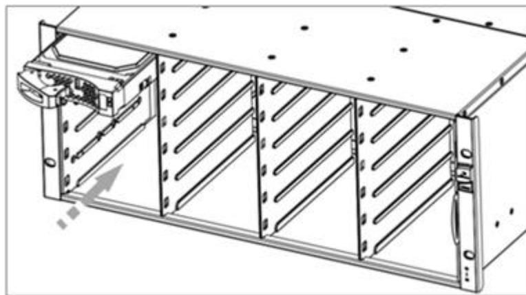
图6-33 安装 3.5 英寸磁盘模块示意图（二）
