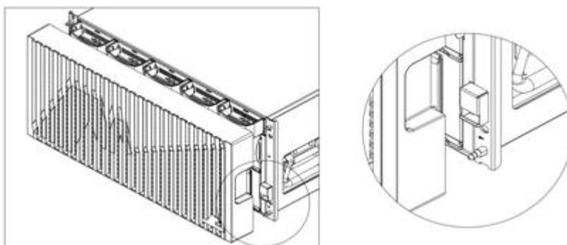
图6-1 安装/拆卸 SPU 面板示意图
