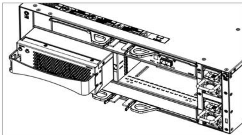
图6-14 安装/拆卸 DSU2624 风扇模块示意图
