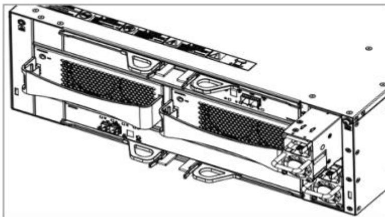
图6-21 安装/拆卸 DSU2624 电源模块示意图
