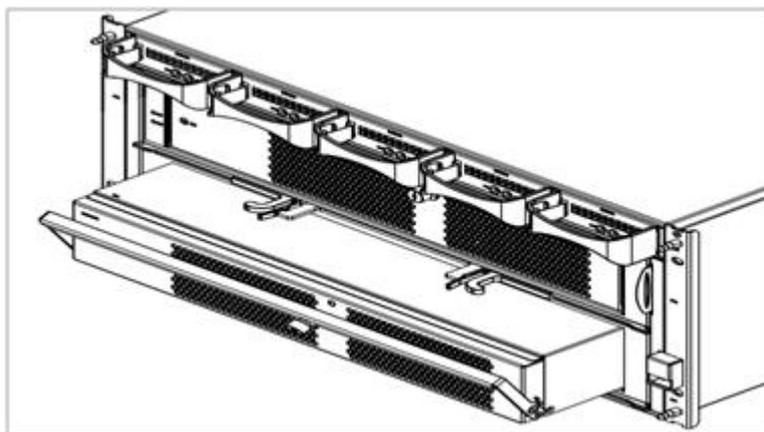
图6-3 安装/拆卸 SPU 风扇模块示意图
