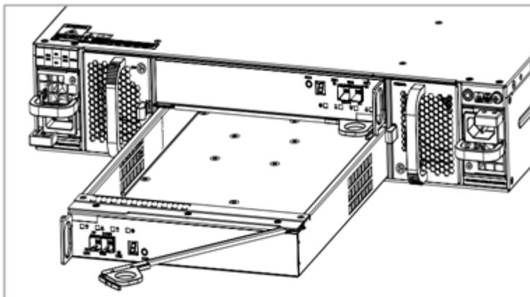
图6-6 安装/拆卸 DSU2625 EP 示意图
