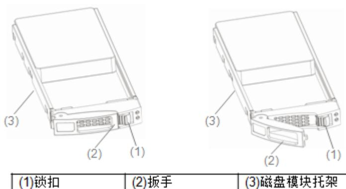
图6-26 2.5 英寸磁盘模块 B 示意图
