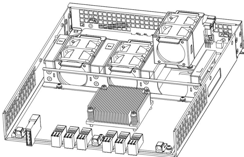
图6-16 安装/拆卸 DSU2725B/DSU2725 内置风扇模块示意图
