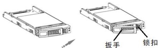
图6-24 安装 2.5 英寸磁盘模块 A 示意图（一）
