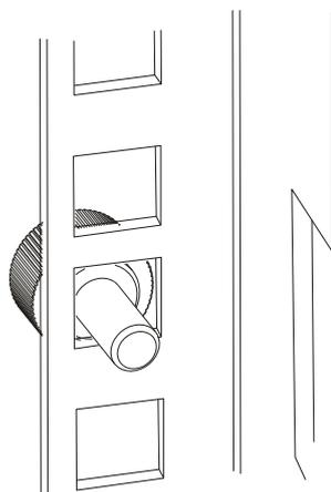
图7-5 拇指螺钉错误安装示意图（一）
