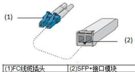
图4-42 FC 线缆和接口示意图
