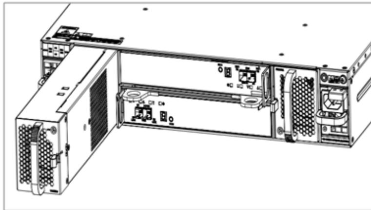
图4-18 安装 DSU2625B 风扇模块+电池模块示意图
