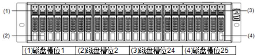
图6-23 DSU2625B/DSU2625 磁盘槽位编号示意图
