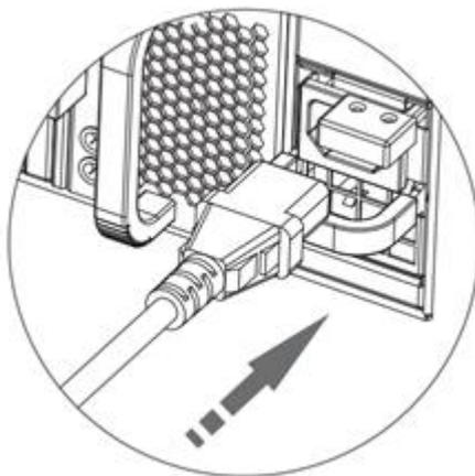
图4-32 安装电源线示意图 (二)
