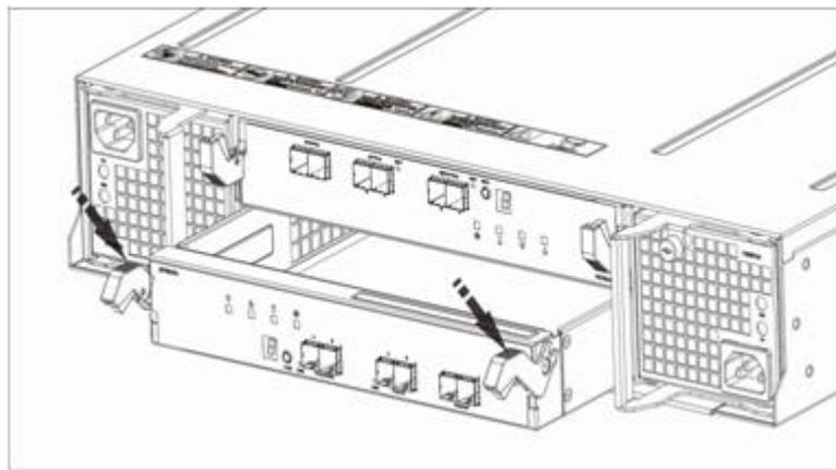
图6-9 安装/拆卸 DSU5625 EP 示意图
