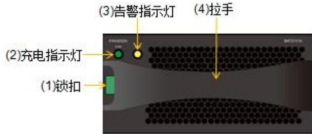
图3-24 DSU2624B 风扇模块+电池模块正视图
