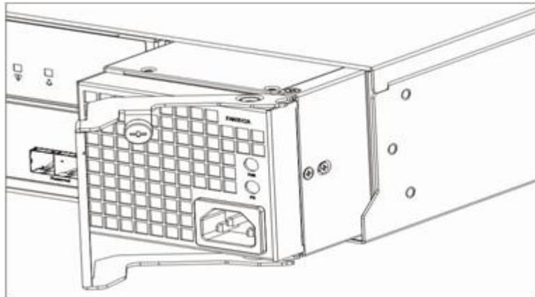
图6-18 安装/拆卸 DSU5625B 风扇模块+电池模块+电源模块示意图
