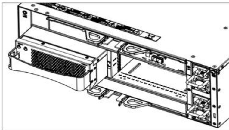
图4-19 安装 DSU2624B 风扇模块+电池模块示意图
