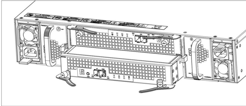
图6-8 安装/拆卸 DSU2725 EP 示意图
