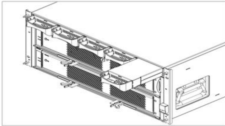
图6-4 安装/拆卸 SPU 电池模块示意图
