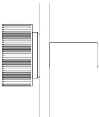
图7-7 拇指螺钉错误安装示意图（三）
