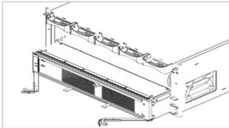
图6-2 安装/拆卸 SP 示意图
