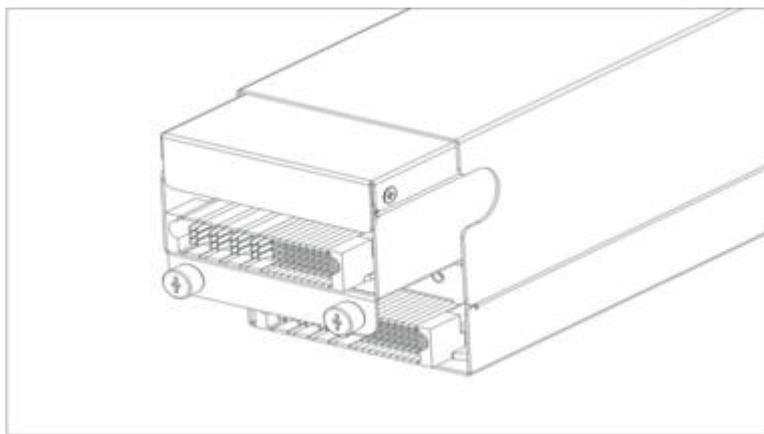
图6-19 安装/拆卸电池模块示意图
